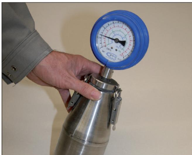
**1** Détermination de la teneur en humidité de la chape sulfate de calcium avec l'indicateur CM. Teneur maximale en humidité  $\leq 0,5\%$  (non chauffée) ou  $\leq 0,3\%$  (chauffée).
