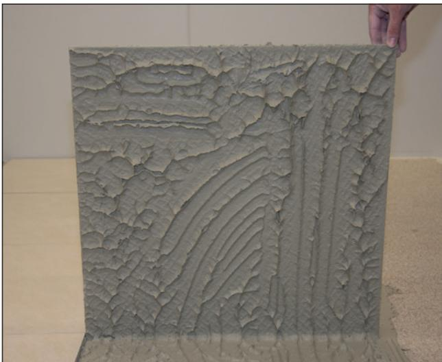
**5** La Colle Sopro VarioFlex® XL assure un transfert optimal, pratiquement sans „zone creuse”, au dos des éléments.
